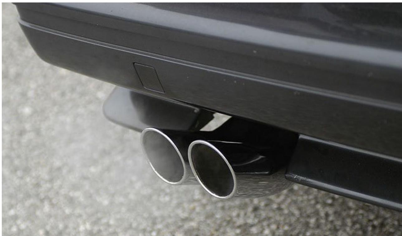
A questo va aggiunto che tutti i componenti Supersprint sono realizzati in acciaio inox 304, materiale che grazie alle proprie caratteristiche oltre ad una durata pressoché eterna consente di realizzare i particolari con uno spessore inferiore delle lamiere, a tutto vantaggio del peso.
