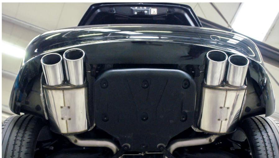
Infine, per accontentare al massimo la clientela, Supersprint offre due differenti soluzioni di terminali di uscita: due tubi, ovali-ellittici da 120x80mm, uno per lato che si sposano perfettamente allo spoiler paraurti di serie, oppure quattro tubi, due per lato sempre ovali-ellittici da 120x80mm, studiati per il kit aerodinamico originale Mercedes-AMG.
