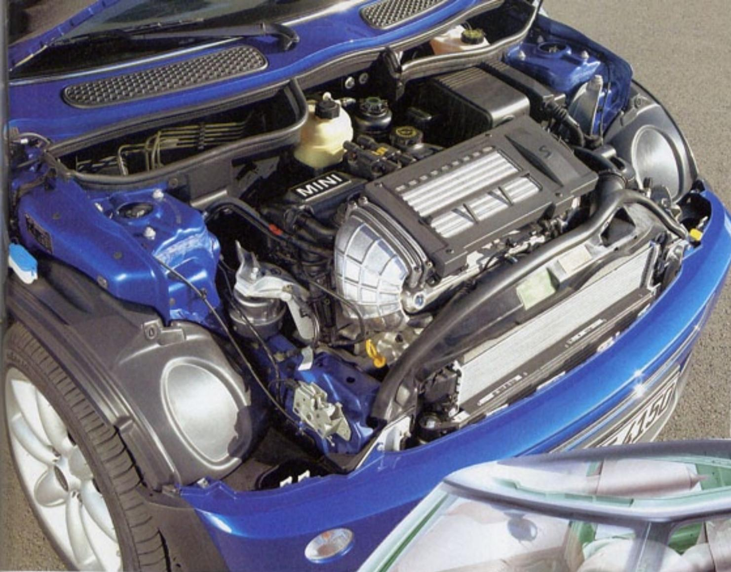
ottenuta con un compressore volumetrico di tipo Roots che lavora ad una pressione di esercizio massima pari a 0,8 bar.
