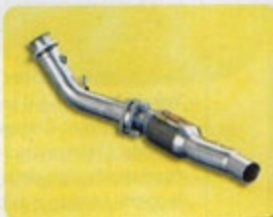
Kit scarico anteriore destro e sinistro con catalizzatori ad alte prestazioni HJS a 100 CPSI OBD. Prezzo di listino 2.707 Euro
