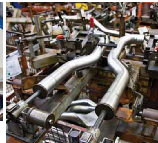
Turbo Rudi zavaruje cijevi ručno, brzo i precizno (gore). Jigovi, odnosno šablone za smještanje cijevi tijekom zavarivanja (desno i dolje lijevo)
