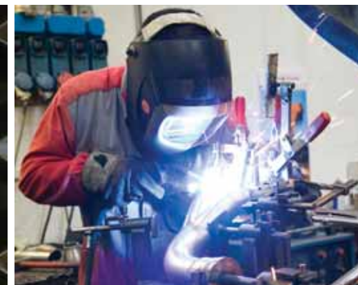
Turbo Rudi zavaruje cijevi ručno, brzo i precizno (gore). Jigovi, odnosno šablone za smještanje cijevi tijekom zavarivanja (desno i dolje lijevo)
