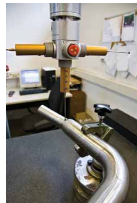
Troosno pipalo izrađuje 3D nacrt onoga što će iz prototipa postati novi sportski ispušni sustav
