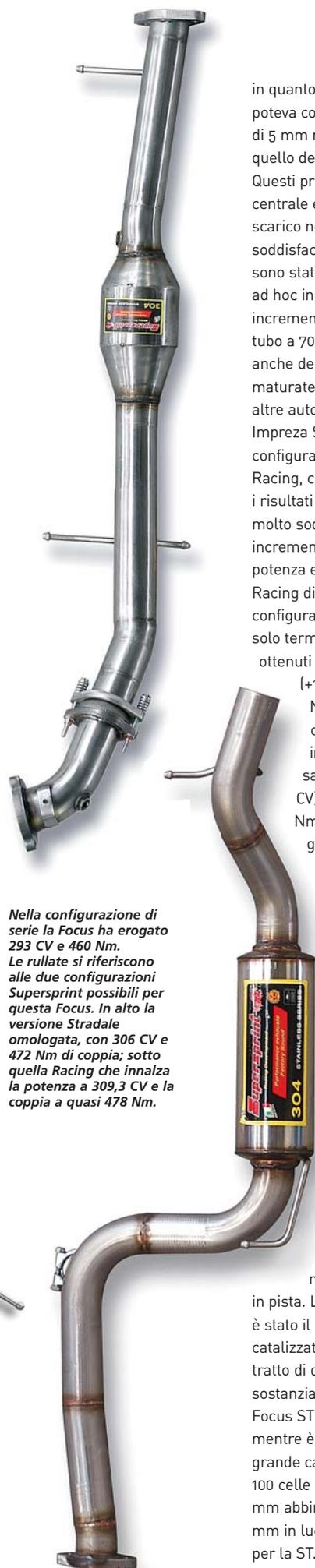
**Nella configurazione di serie la Focus ha erogato 293 CV e 460 Nm. Le rullate si riferiscono alle due configurazioni Supersprint possibili per questa Focus. In alto la versione Stradale omologata, con 306 CV e 472 Nm di coppia; sotto quella Racing che innalza la potenza a 309,3 CV e la coppia a quasi 478 Nm.**
