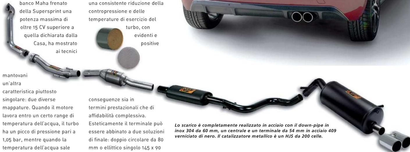
Lo scarico è completamente realizzato in acciaio con il down-pipe in inox 304 da 60 mm, un centrale e un terminale da 54 mm in acciaio 409 verniciato di nero. Il catalizzatore metallico è un HJS da 200 celle.
